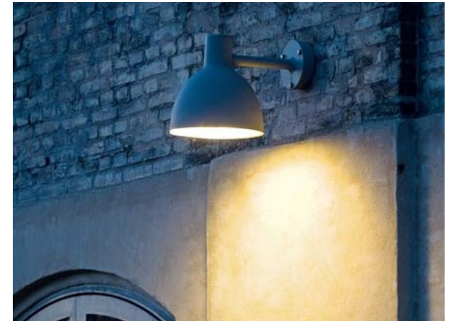
Verlichting Door verlichting aan de gevel of aan draden te hangen, blijft het maaiveld vrij van objecten (en van fietsen, die daar weer tegenaan gezet kunnen worden). Groenstructuren worden niet aangelt.
